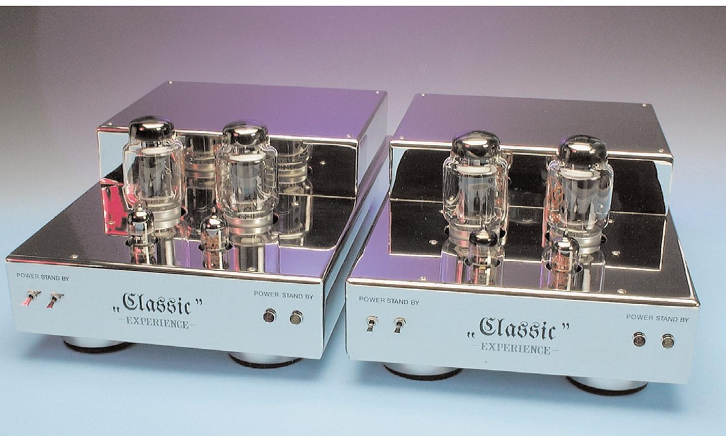
Le concept sur lequel repose l'étage de sortie décrit dans le présent article est celui de la technologie PPP (d'où le P<sup>3</sup> du titre). Ce P<sup>3</sup> est l'acronyme de *Parallel Push-Pull*. Ce fameux *Push-Pull* signifie que l'étage de puissance est monté en circuit push-pull c'est-à-
